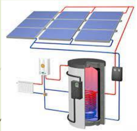
Solarthermie EFH Quelle: Paradigma
